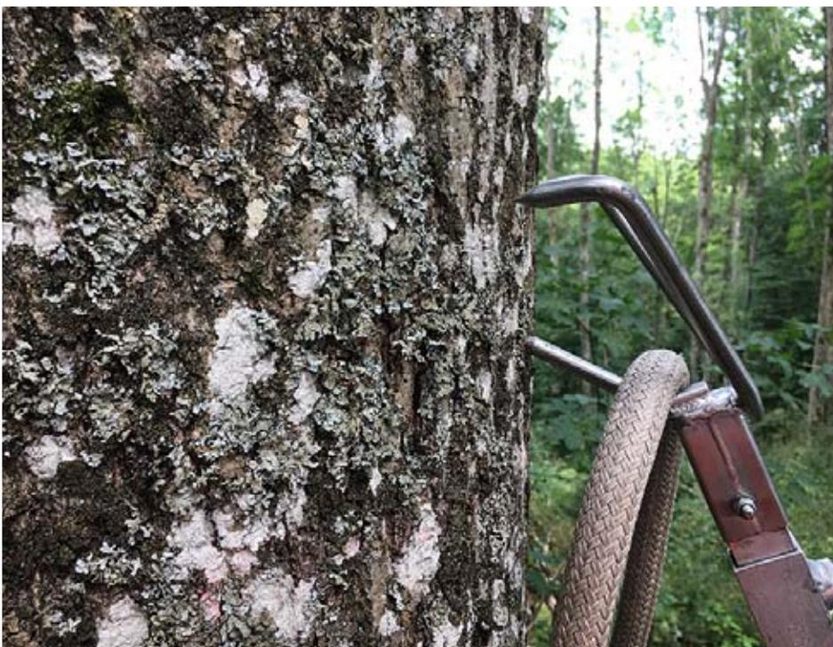
Mit einer Totholzkralle wird das Seil am Baum angestellt. Beim Anziehen kann so der Gefahrenbereich verlassen werden.
