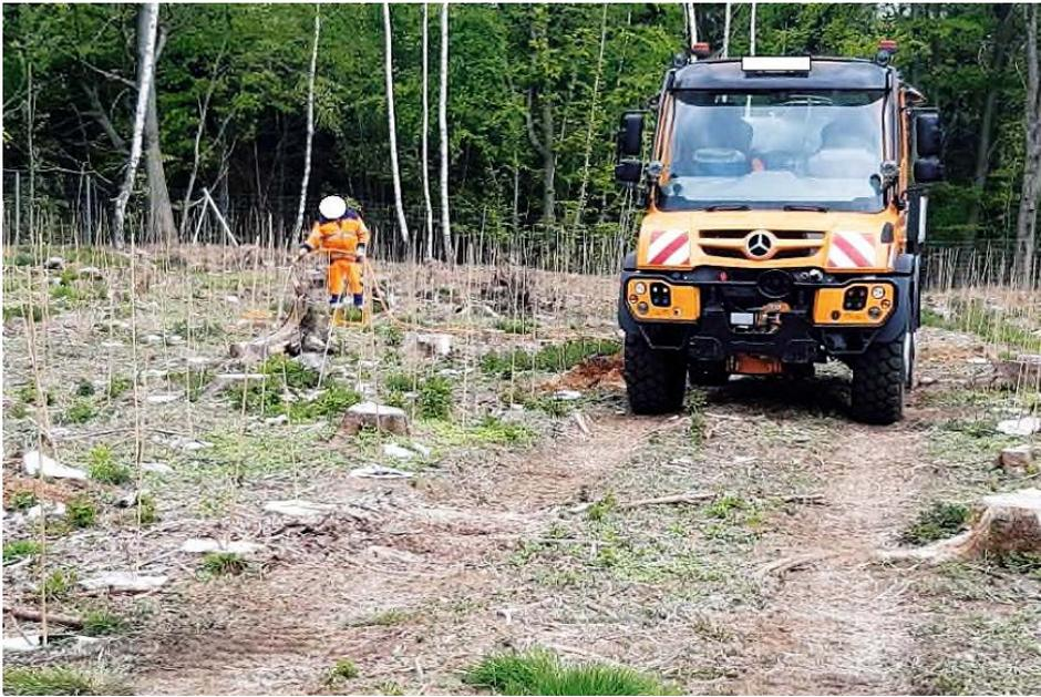
**Abb. 2:** Schlauchbewässerung mit Tank 2000 L, Stromaggregat und Tauchpumpe von der Rückegasse aus.
