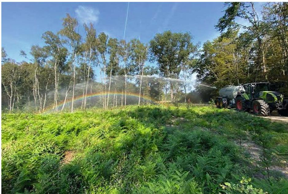
Abb. 1: Flächige Bewässerung mit einem Traktor, Tankhänger (20.000 L) und Wasserkanone.
