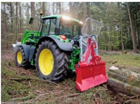
Bild 1: Tajfun-Seilwinde in Kettenbauart im Einsatz. Lieferbar von 35...100 kN Nennzugkraft.
