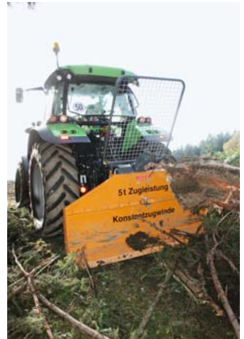
Bild 10: Konstantzugwinde der Firma Ritter mit 5 t Nennzugkraft und gleich hoher Betriebszugkraft.
