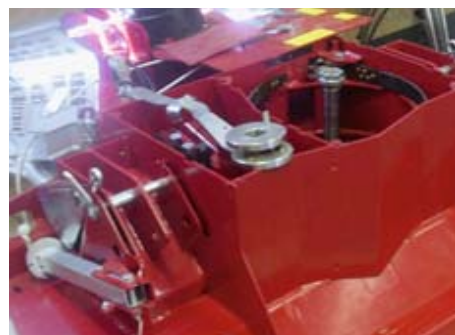
Bild 6: Einbaubereich der Trommel mit Trommelachse in Fahrzeuglängsrichtung
