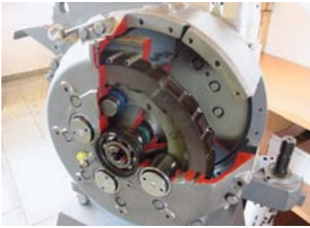
Bild 8: Haltebremse einer Getriebeseilwinde in Lamellenausführung (Pfanzelt)
