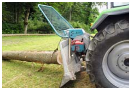
Bild 3: Doppeltrommel-Getriebeseilwinde von Pfanzelt. Lieferbar in zwei Baureihen von 55... 2 x 80 kN Nennzugkraft
