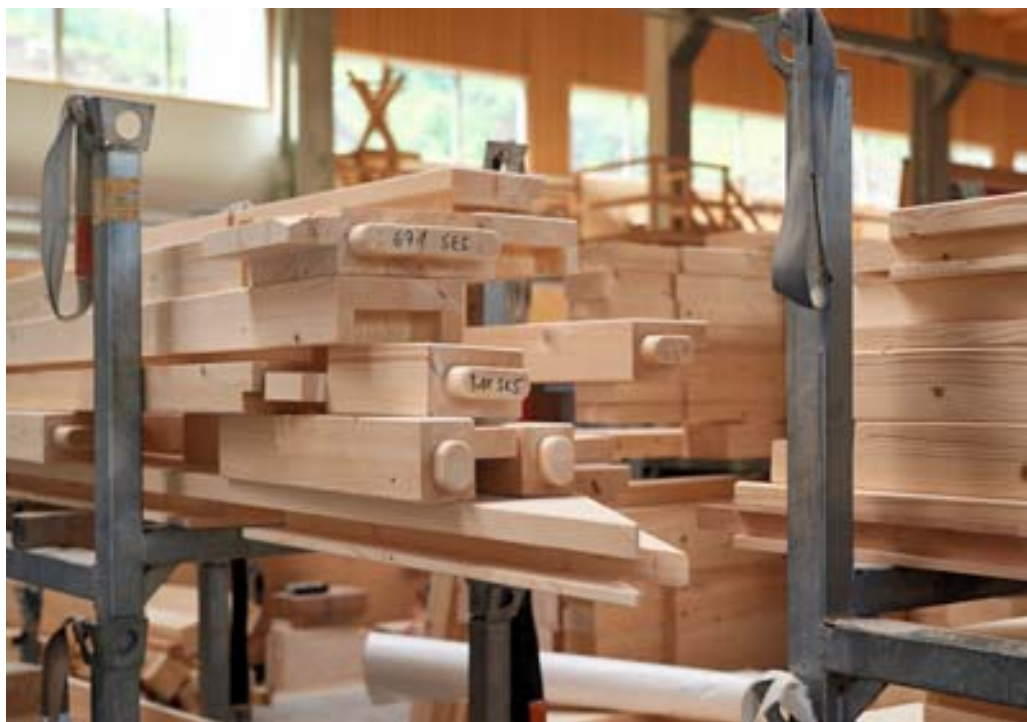
Abb. 1: Sägerauhes Listenbauholz ist im Bausektor durch Konstruktionsvollholz (KVH) weitgehend abgelöst.
