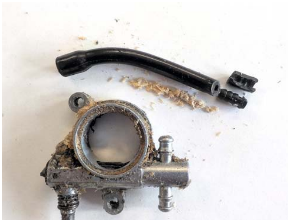
Defekte Ölpumpe mit verstopfter Schmierölleitung.
