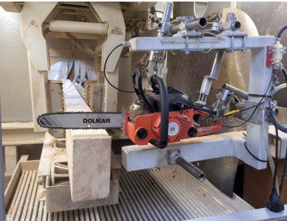
Dauerlaufprüfstand mit Konstruktionsvollholz. © KWF
