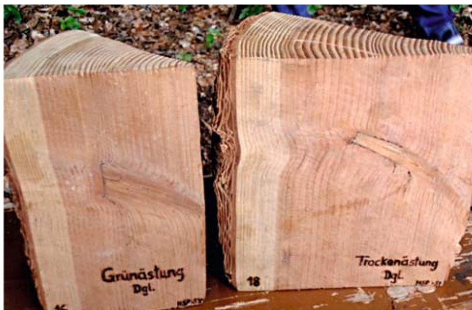
Vergleich einer Trockenästung mit einer Grünästung und die Auswirkungen auf die Holzqualität.
