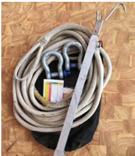
1. Baumzugseil aus ummantelter Dyneema-Faser mit zwei Schlaufen, Länge 12 m, Seiltyp Stratos Winch (17 mm)
