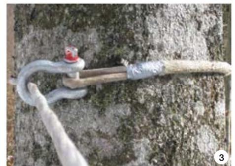
Mit dem Einziehen des Windenseiles schließt sich die Seilschlinge.
