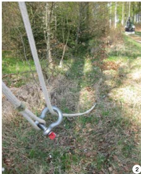
Mit der Anschlagkralle wird das Seil entgegen der Fällrichtung in der gewünschten Höhe fixiert.
