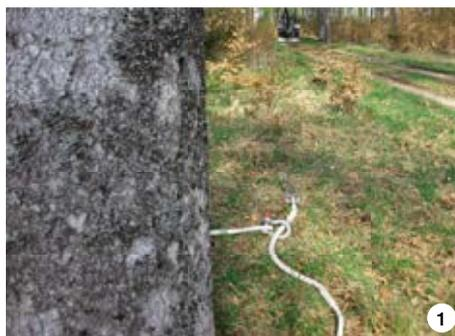
Das Anschlagseil wird um den Stammfuß ausgelegt und mittels Schäkel zu einer Schlinge verbunden. Der zweite Schäkel stellt die Verbindung zum Windenseil her.
