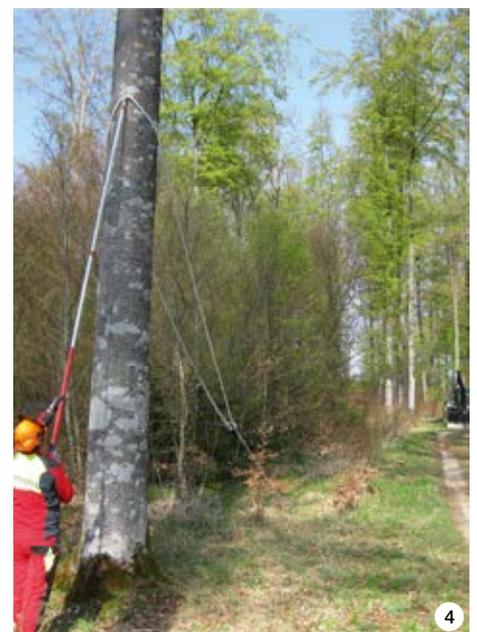
**Merke:** Stets den korrekten Verlauf des Seiles kontrollieren. Der Umlenkwinkel des Seiles am Schäkel soll kleiner  $15^\circ$  sein!
