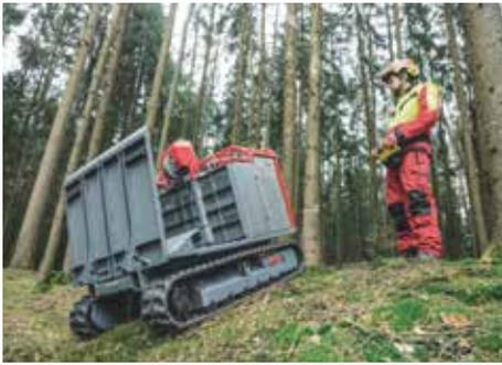
Abb. 1: Mit seinen kompakten Maßen (Länge: 2.080 mm, Breite 1.200 mm, Höhe: 1.610 mm) und seinem geringen Gesamtgewicht (1,6 t) spielt der Suffer SmartSkidder vor allem in unzugänglichen Gebieten seine Stärken aus.
