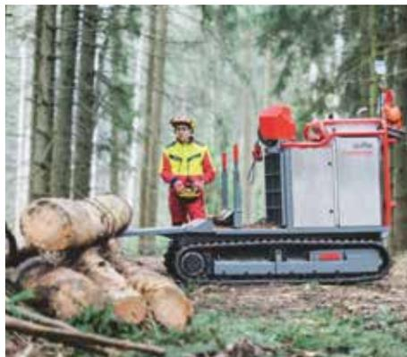
Abb. 4: Mit dem hydraulischen Rampenschild lässt sich das Langholz ganz leicht am Waldweg poltern.
