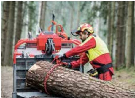
Abb. 2: Die Seilwindenzugkraft von 4 t macht den Suffer SmartSkidder zu einem kleinen Kraftpaket.
